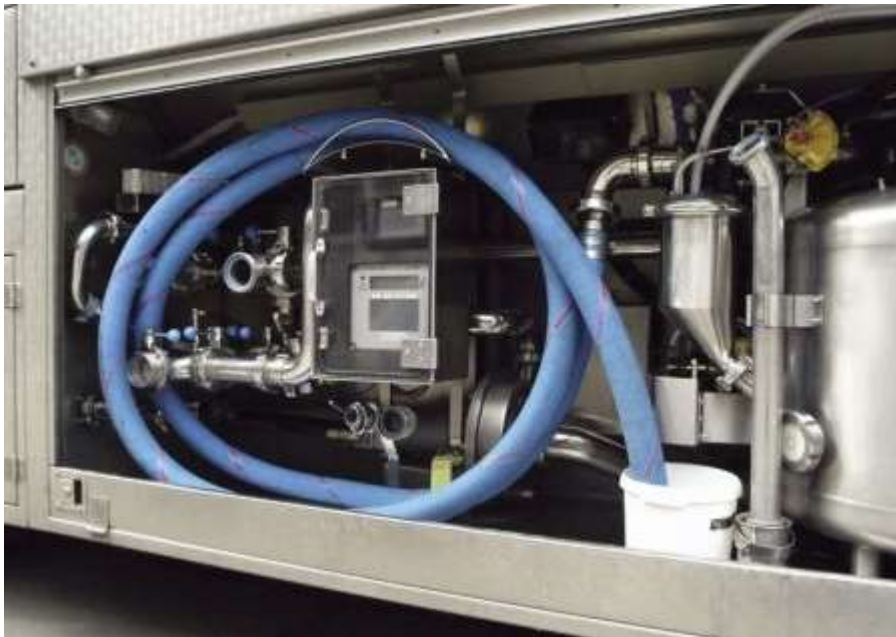
Abb. 7: Milchsammelwagen, Auffangen von Tropfmilch mittels Eimer (Foto: © LAVES)
