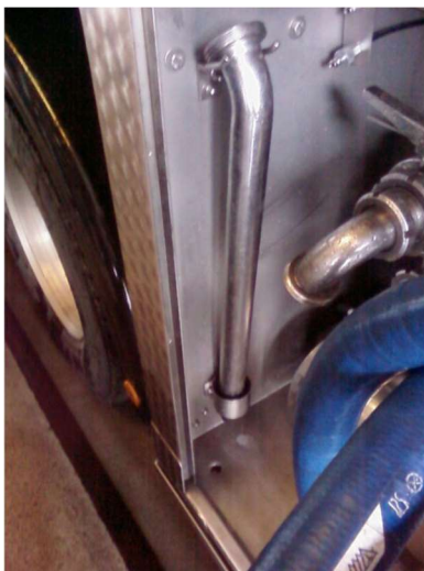
Abb. 5: Milchlanze sowie Öffnung im Fahrzeugboden (Foto: Gierke 2010, © LAVES)
